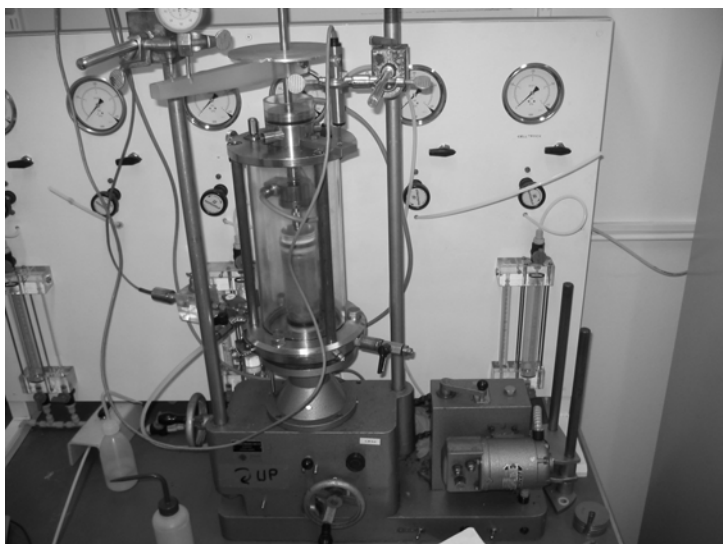
Bild 4.7 Försökupställning för triaxialförsök
