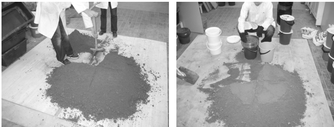
Bild 4.1 Koning och kvadrering av material Bild 4.2 Bortsiktning av material >20 mm
